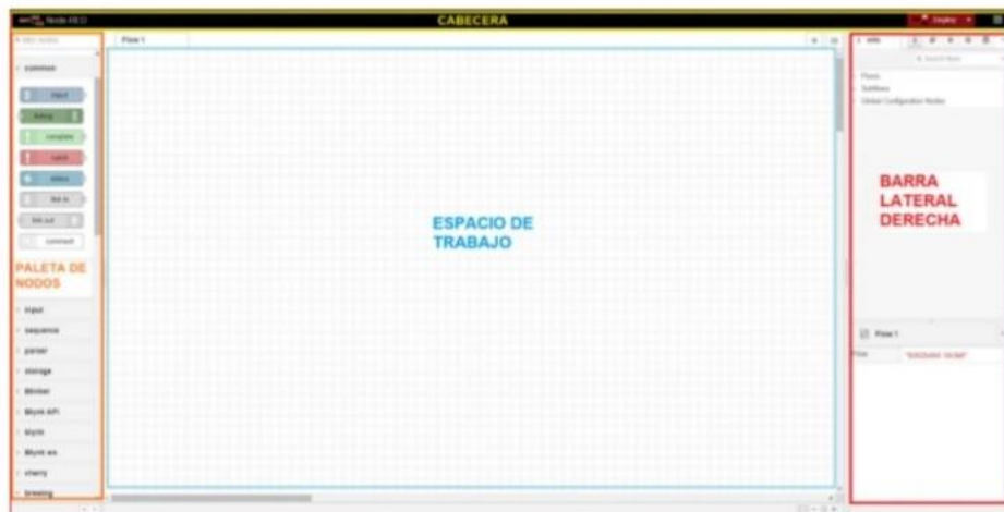
Figura 4 Estructura del espacio de trabajo Node-Red.
